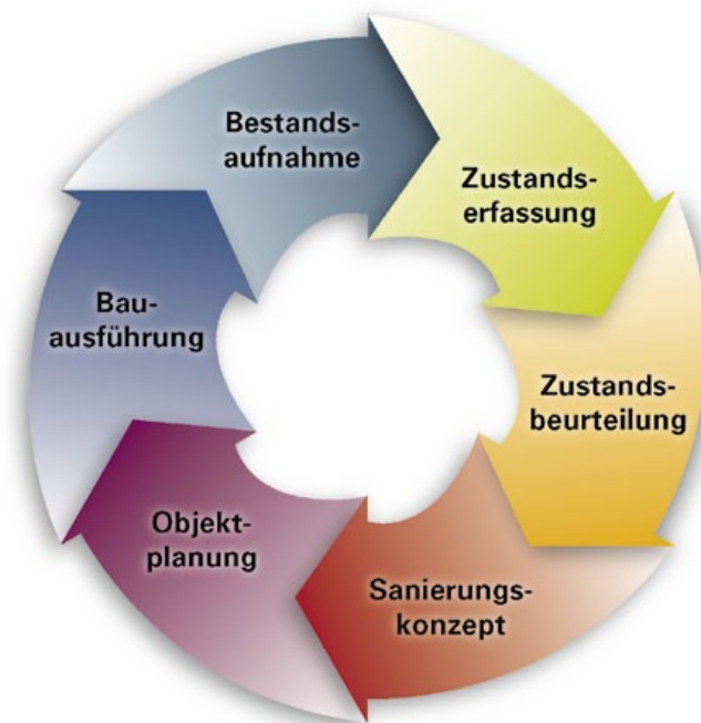
Abb. 11: Eine runde Sache – sechs Schritte zur erfolg- reichen Kanalsanierung
