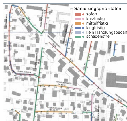
Abb. 20: Sanierungsbedarf im Überblick
