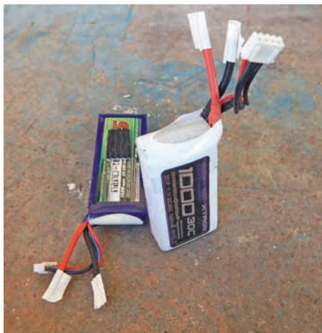
So werden Pole richtig abgeklebt.
